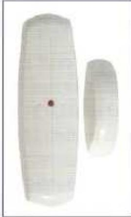
Los detectores magnéticos se instalan directamente sobre la superficie a proteger. Detectan la apertura de puertas, ventanas o persianas. Constan de dos piezas, una el propio detector, que siempre debe colocarse en la parte fija ( marco de la puerta o ventana ), y un imán que colocaremos en la parte móvil ( puerta, persiana ).
